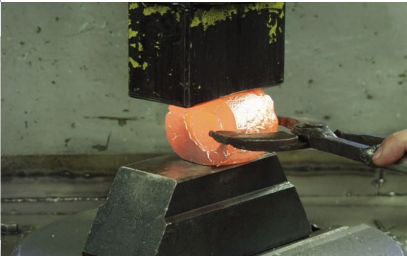
Горячая обработка слитка на ковочном молоте
